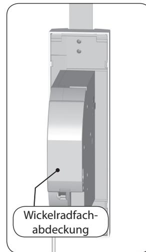
Bauen Sie den superrollo GW250 / GW255 möglichst gerade ein, damit sich das Gurtband korrekt aufwickeln kann.
