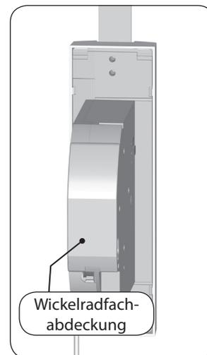
Bauen Sie den superrollo GW190 / GW195 möglichst gerade ein, damit sich das Gurtband korrekt aufwickeln kann.
