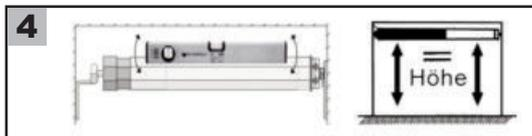
**i** Montieren Sie das Motorlager so, dass die Schrauben für die Endlageneinstellung am Motorkopf später gut zugänglich sind und das Motorkabel ohne Knick nach unten hin verlegt werden kann.
