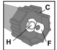
**Montage des Adaptersets (Laufring und Mitnehmer):** Den Laufring (D) soweit über das Motorrohr schieben, bis er **vollständig und fest** in der im Endanschlag (J) enthaltenen Führung (K) sitzt! Nun den Mitnehmer (C) auf die Motorwelle (H) stecken und diesen mit dem Seeger-Ring (F) sichern.
