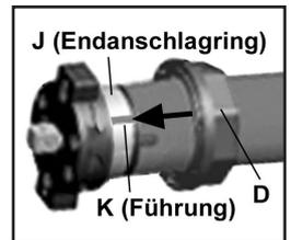
**Ausbau der Wickelwelle:** Den Rollladen ganz herunterlassen. Rollladenkasten öffnen und den Behang von der Welle abnehmen. Die Rollladen-Handbedienung (Gurt und Gurtscheibe) entfernen und die Welle herausnehmen.
