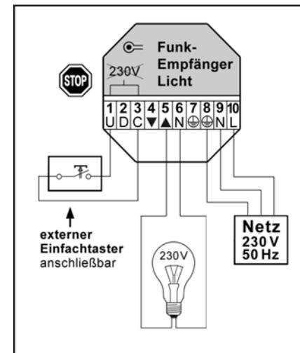
Bei Bedarf kann an den Klemmen 1 und 3 ein externer Einfach-Taster angeschlossen werden:
